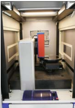
Singulase LD10 sisältä. Keskellä näkyy oranssi Corelase X-lasen työstöpää.
